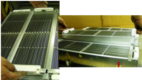
Rys. Nr 46 Demontaż / Montaż sekcji katodowych
