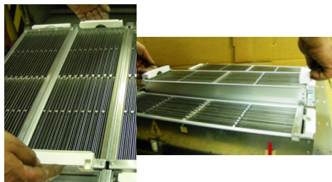
Рисунок №46 Демонтаж / монтаж катодных секций
