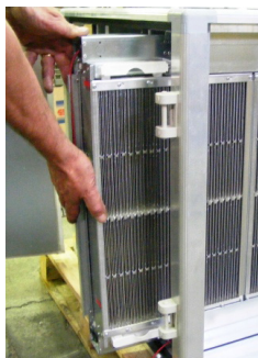
Рисунок №45 Демонтаж / Монтаж фильтров в установке
