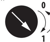
РИС. 12: Настройки направления вращения сервоприводов
