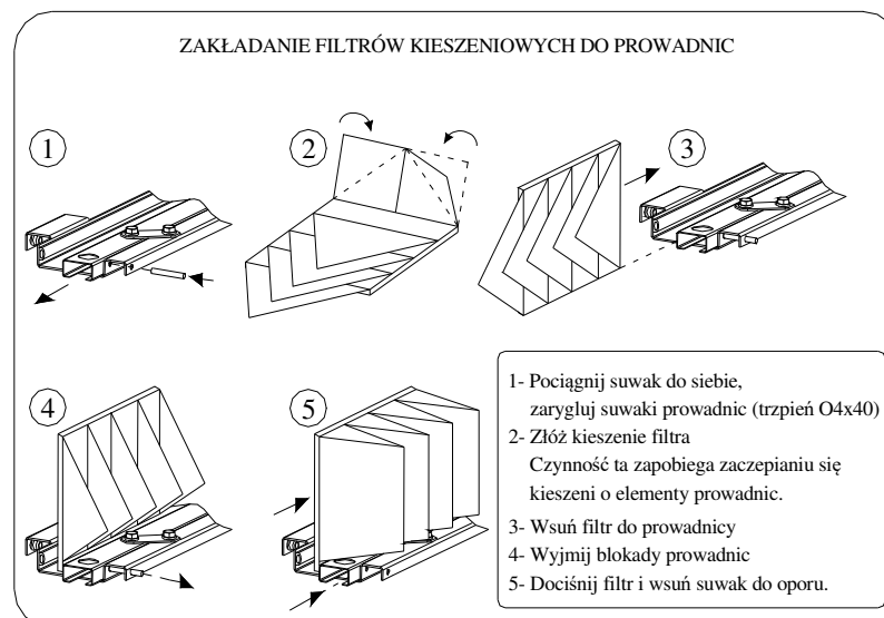
Rys. Nr 36 Montaż filtra kieszeniowego
